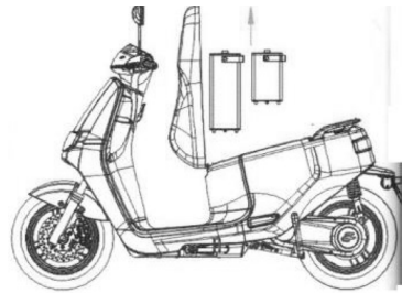
مدل E2 با قابلیت نصب دو باتری
